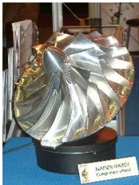
Centrifugal impeller blade. Photo: S. J. de Waard
